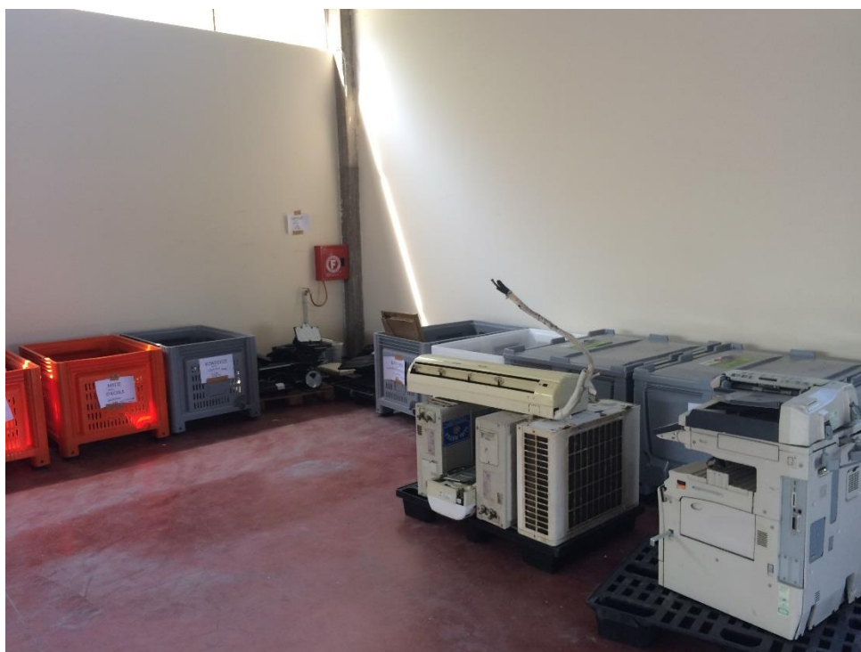
Εικόνα 4: Διακριτή αποθήκευση ΑΗΗΕ ανά υποκατηγορία προς περαιτέρω προετοιμασία για επαναχρησιμοποίηση σε ειδικά μέσα συλλογής της μονάδας (δοκιμαστική παραλαβή).
